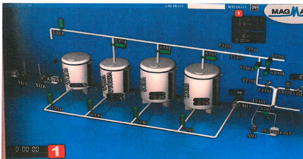
Rys. 1. Schemat stacji CIP. Źródło: materiały techniczne instrukcji urządzenia.
